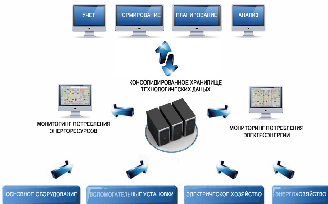
Структура ПТК управления потреблением энергоресурсов в цехе промышленного предприятия
