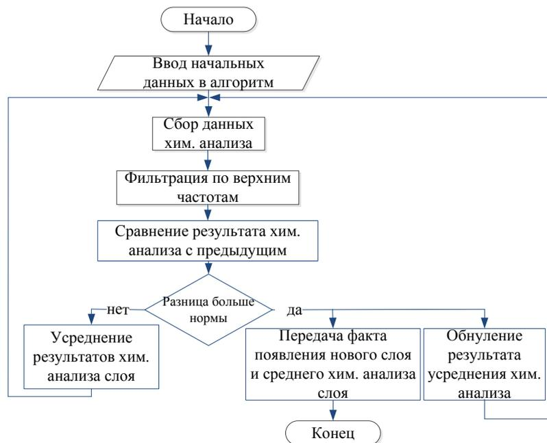
Рис. 2. Алгоритм работы подсистемы определения химического состава материала
